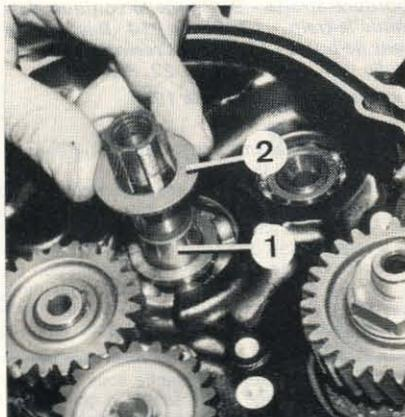
**PHOTO 56 : 1. Arbre primaire - 2. Rondelle de butée (Photo RMT)**
