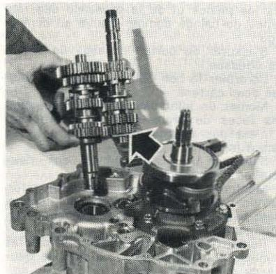
PHOTO 60 : Sur le moteur CM 125 C, la rondelle fine va à l'extrémité gauche de l'arbre primaire (Photo RMT)
