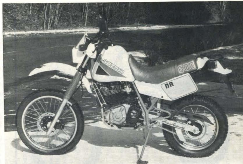
suspension arrière est d'ailleurs confiée à un vrai « Full-Floater » puisque l'amortisseur est actionné par le haut et par le bas.
