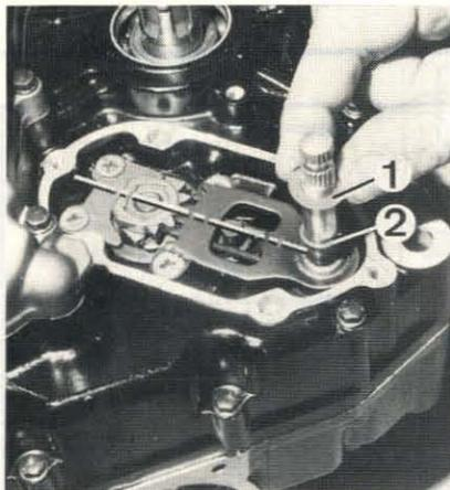
**PHOTO 61 : Mécanisme de sélection**
