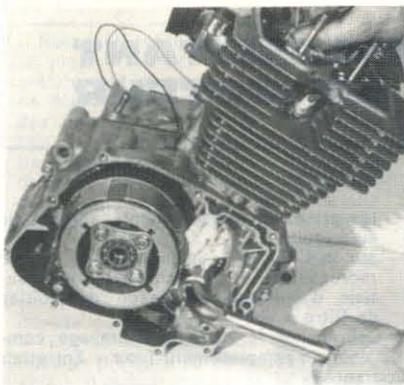
**PHOTO 41 :** Méthode de blocage de la transmission primaire avec un chiffon plié plusieurs fois entre les pignons (Photo RMT)
