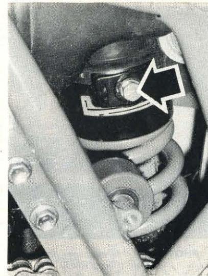
**PHOTO 27 :** Vis de réglage de dureté d'amortisseur arrière (Photo RMT)
