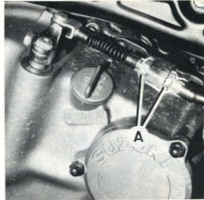
PHOTO 18 : Écrous du tendeur inférieur du câble d'embrayage (Photo RMT)
