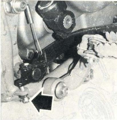
PHOTO 33 : Vis de butée de pédale de frein (Photo RMT)
