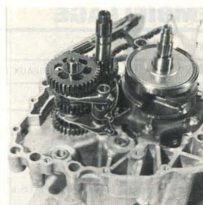
**PHOTO 61 : Les trois fourchettes du moteur CM 125 C (Photo RMT)**
