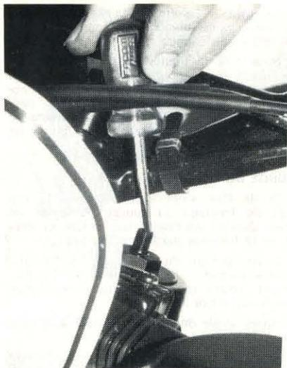
**PHOTO 24 :** Il ne doit pas y avoir d'air sous pression dans la fourche (Photo RMT)
