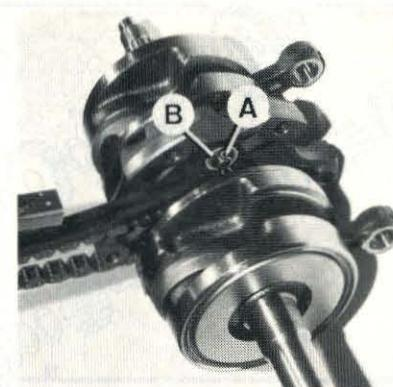
PHOTO 64 : Dépose du patin de tension
