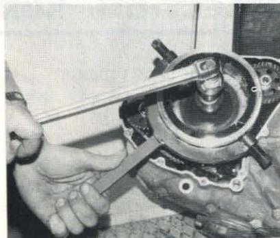
**PHOTO 62 : Desserrage de la vis de rotor d'alternateur (Photo RMT)**
