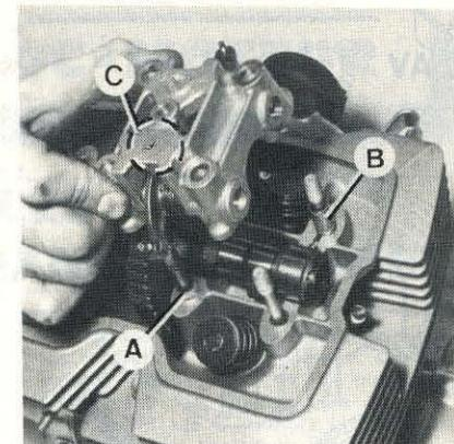
**PHOTO 30 :** Repose d'un palier de l'arbre à cames
