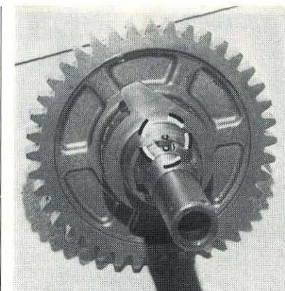
PHOTOS 75 et 76 : Repères à aligner au réassemblage du mécanisme de kick (Photos RMT)
