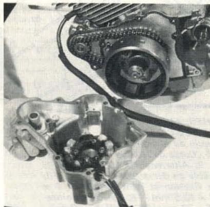
PHOTO 32 : Dépose du couvercle d'alternateur CM 125 C (Photo RMT)
