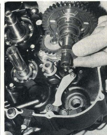
PHOTO 78 : Repose de l'arbre de kick, sans oublier la rondelle (Photo RMT)
