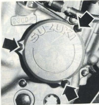
**PHOTO 3 :** Les trois écrous du couvercle de filtre à huile (Photo RMT)
