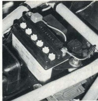
PHOTO 19 : Batterie placée sous la selle (Photo RMT)
