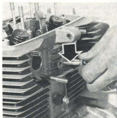
PHOTO 52 : Sur les moteurs CM 125 T et C, un petit joint torique équipe la vis supérieure de fixation du tendeur, ce qui n'est pas le cas de ce moteur CM 250 C (Photo RMT)
