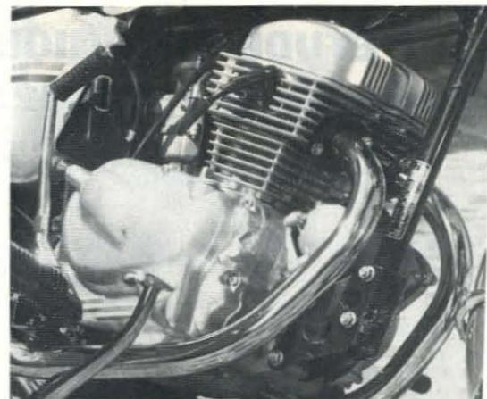
Le moteur CM 125 T ne se différencie extérieurement de son homologue CB 125 T que par la présence du démarreur électrique (Photo RMT)
